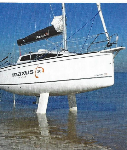
Le Maxus 26 se décline en quatre versions de lest, dont la biquille, qui permet un échouage facile, en appui sur le safran et les deux quilles.
